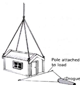
Caixas quadradas geralmente não tem um bom comportamento em voo e apresentam tendência de girar. Uma biruta pode ser utilizada para estabilizar o voo deste tipo de carga. Prender a biruta e uma barra horizontal pode melhorar a estabilização.
