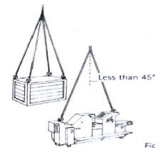
A amarração com dois pontos com ângulo entre os cabos inferior a 45° é o método de amarração mais utilizado para a maioria das cargas. A amarração em quatro pontos também pode ser feita para cargas com a forma cúbica.
