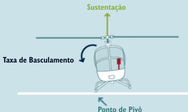
Um deslocamento excessivo do manche coletivo combinado com um movimento de basculamento em torno de um patim/roda pode levar a um ponto de basculamento suficiente para que um curso completo do cíclico na direção oposta não possa contrariar, mesmo antes de chegar ao ângulo de basculamento crítico.
